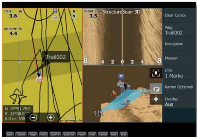
Ausgerüstet mit dem 9-Zoll-Breitbild-Multitouch-Display mit LED-Hintergrundbeleuchtung, Notebook und Tablet, ging es dann auf den Inn um dort den Grund abzutasten. GPS-Unterstützt ist es möglich, Fundstellen zu markieren um später Navigationsgestützt die Stelle wieder zu finden.
